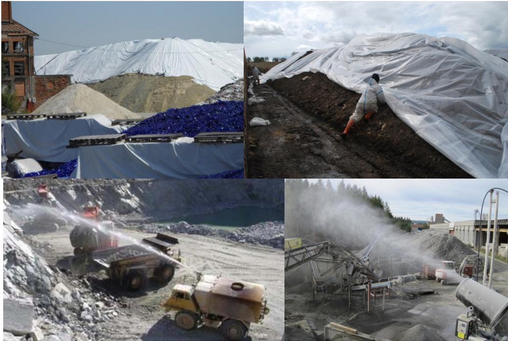
*Figura 6.2-3 Esempi di sistemi di copertura e di abbattimento delle polveri a mezzo bagnatura*
