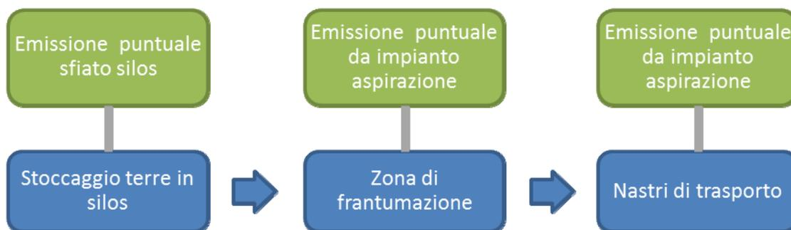
Figura 5.4.1-1 Diagramma a blocchi e sorgenti emissive esercizio CI13 e C14
