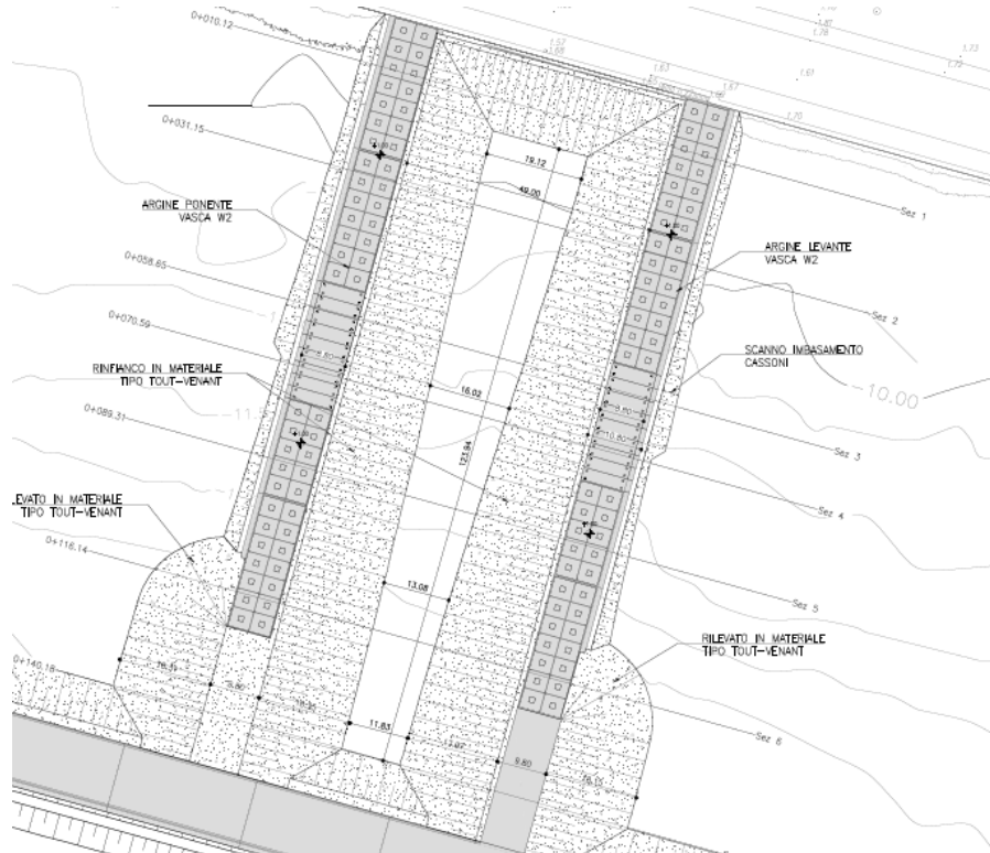
Figura 2-10. Planimetria generale di progetto della Vasca W2
